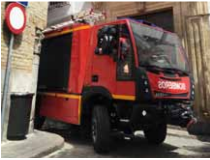
Aebi MT mit Tanklöschaufbau
