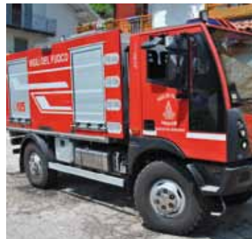
Aebi MT mit Tanklöschaufbau
