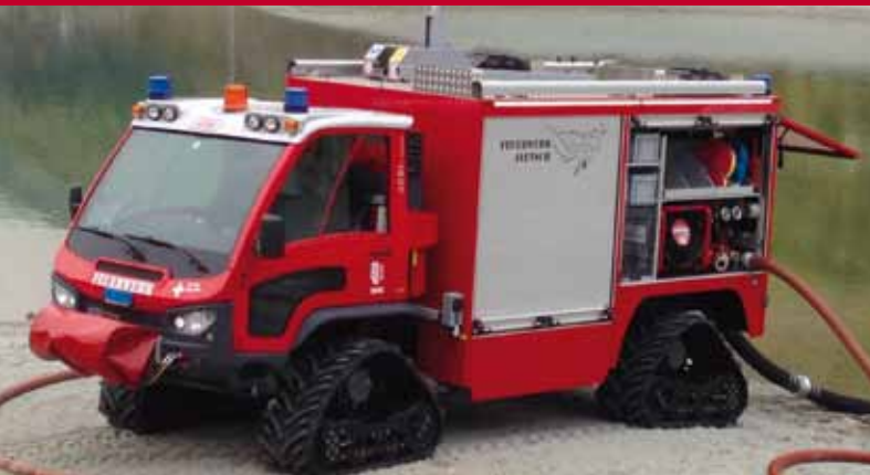
Aebi VT450 Vario mit Raupenfahrwerk und Tanklöschaufbau
