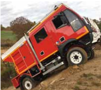
Aebi MT mit Doppelkabine, Wasser- und Trockenstoffbehälter. Wasserdüsen im Überrollbügel für Einsatz bei Waldbrandbekämpfung
